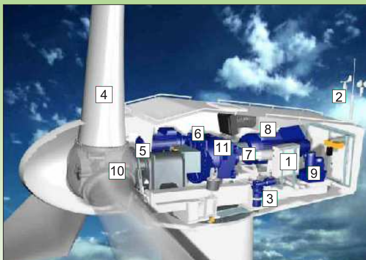
1 - Automate 2 - Girouette 3 - Moteurs d'orientation 4 - Pales 5 - Axe lent 6 - Multiplicateur 7 - Axe rapide 8 - Génératrice 9 - Unité hydraulique 10 - Roulements 11 - Frein à disque
